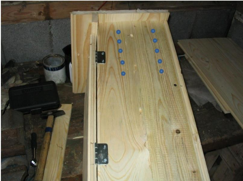
Zur späteren Fixierung der Waben im Haus benutze ich gerne festen Draht (z.B. Kupferkabel 2.5mm), hierzu werden in die Seitenteile 2 Reihen Löcher ca. 3-4mm im Abstand von ca. 20mm gebohrt. Damit kann ich den Draht grob durchfädeln und dann an die Wabe biegen. Alternativ werden auf den Seitenteilen innen Leisten 10x10 aufgenagelt, die dann als Auflagen für Stützleisten dienen.
