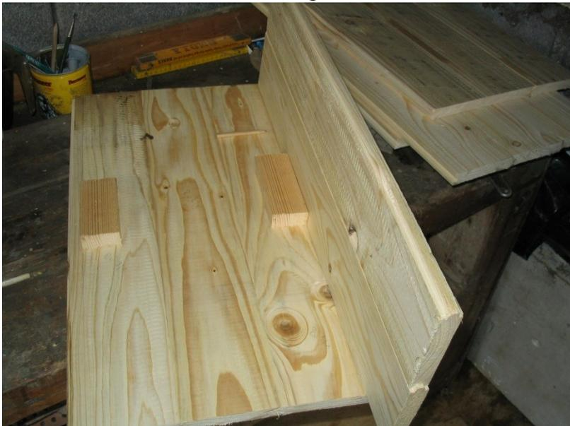
Die Rückseite wird mittig vorgebohrt, danach die Seitenteile aufgeschraubt. Den rechten Winkel können wir nachher noch korrigieren. Vorab reicht das Hilfsklötzchen.
