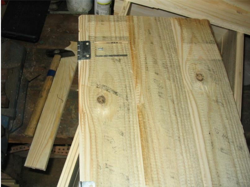
Danach kann die Türe auf die Seitenteile gelegt werden und die Scharniere auf dem Seitenteil markiert werden. Wenn die Seitenteile korrekt sitzen, muß die Türe auf beiden Seiten auf den Seitenteilen aufliegen.
